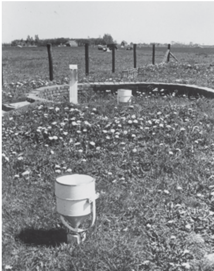
4. De opstelling van regenmeters voor het verdampingsonderzoek in de Rottegatpolder te Groningen, 1955.
