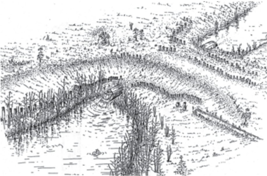
Afb. 4. De werking van een klepduiker (B. Koster, VLAK).
