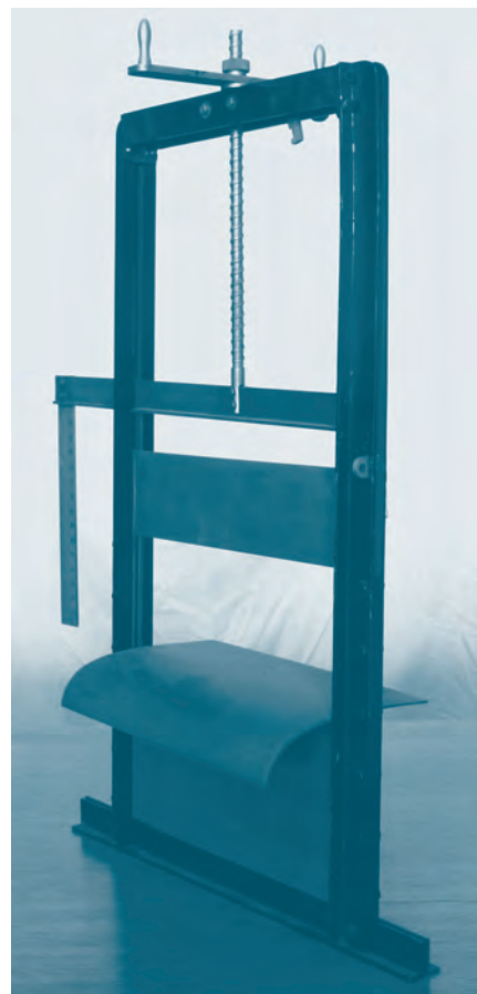
Afb. 4. Schaalmodel van een Romijnoverlaat als gebruikt in het onderwijs. Collectie Technische Universiteit Delft.
