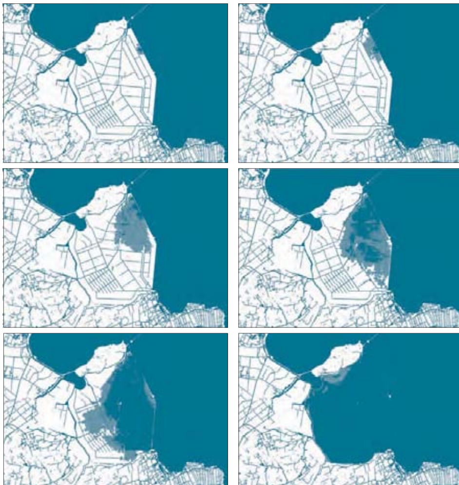
Afb. 6. De ontwikkeling van de inundatie gedurende 48 uur na de doorbraak. Door het grote kombergingsoppervlak verliep de inundatie geleidelijk waardoor iedereen tijdig de polder kon evacueren.
