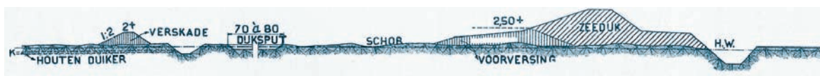
Afb. 3. Achterkade, dijkspuit en voorkade. Ontleend aan P.J. Colijn, Zee- en rivierwerken (Amsterdam 1921).
