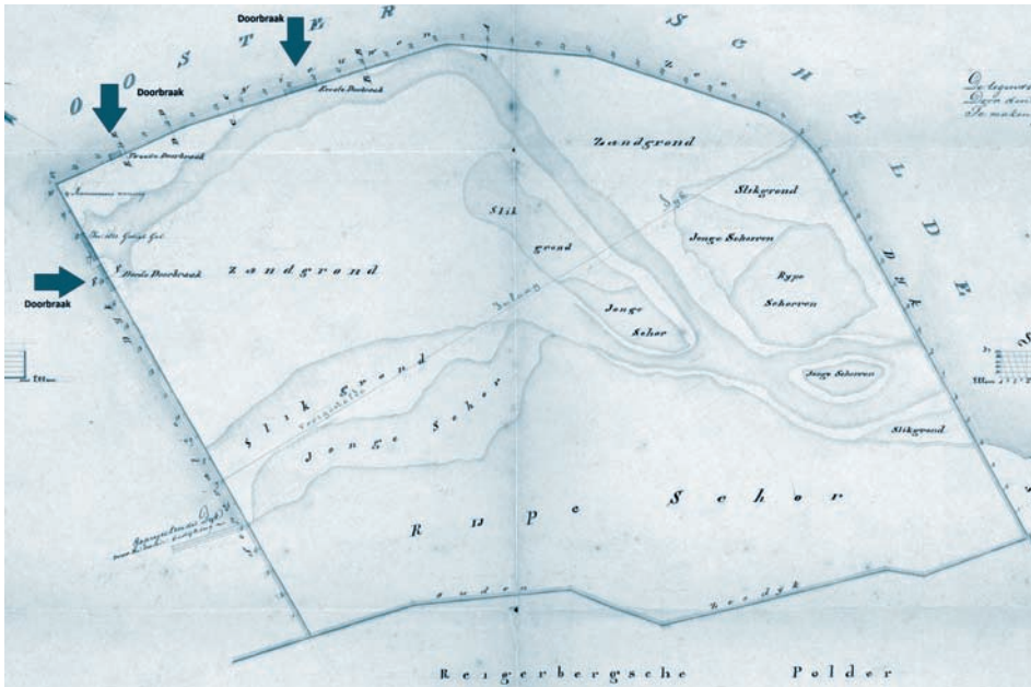
Afb. 5. Stormschade van 26 september 1853 aan de Eerste Polder met drie doorbraakgaten, waarvan er twee op de plek van een voormalige getijdegeul lagen en tot op 0,4 m - NAP waren uitgespoeld. Kaart door J.E.T. Ortt. Zeeuws Archief, tg. 219, NV Landbouwmij. De Bathpolders, NV Zeeuwsche Fruitteelt Mij. inv.nr. 91.
