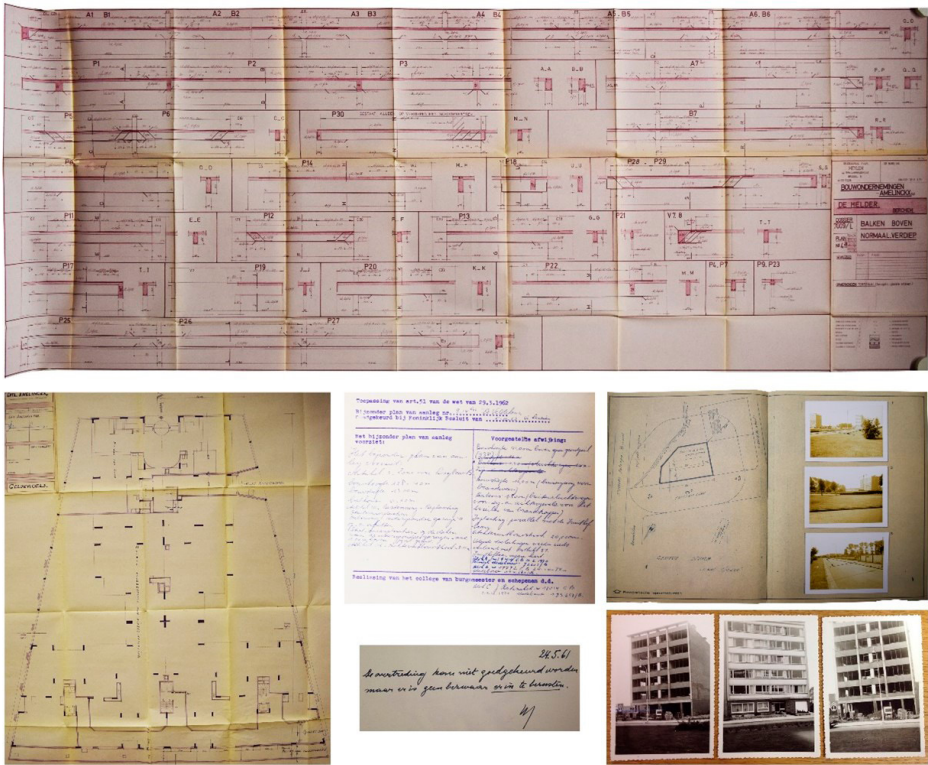
Afbeelding 2. Overzicht van de inhoud van naoorlogse bouwdoSSIERS. Inplantingsplannen, foto's van de originele context, foto's van de constructie, de essentie van het constructiefplan, berekeningen en wapeningsplannen van alle constructieve elementen en veelzeggende correspondentie (Stadsarchief Antwerpen)
